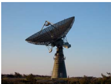
Fig. 1. Onsala rymdobservatoriums 25,6-meterteleskop som invigdes 1965 för observationer av centimeter- till decimeter-långa radiovågor.
