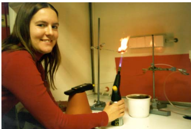
Fig. 5.2: Maria antänder pellets med butanbrännare före provtagning
