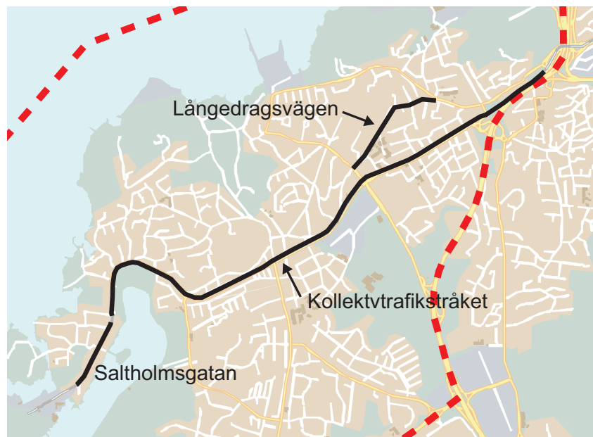
Figur 5.1: Karta över området med kollektivtrafikstråkets lokalisering. Även problempunkten Saltholmsgatan och den del av Långedragsvägen som får ny trafikering finns markerade.
