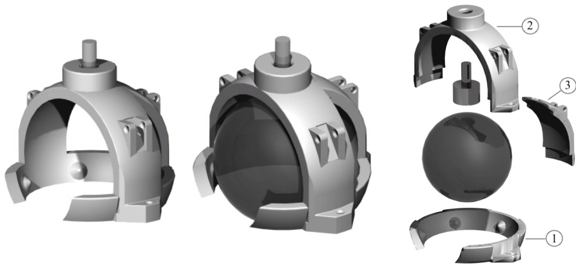
Figur 17: Helhetsbilder och sprängskiss av infästningen
