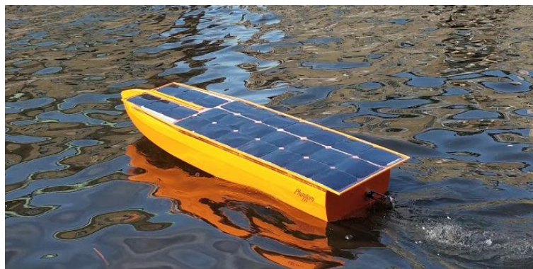
Figur 26, färdig testplattform med solceller
