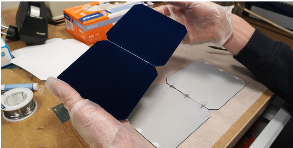
Figur 4, solceller monteras med plasthandskar
