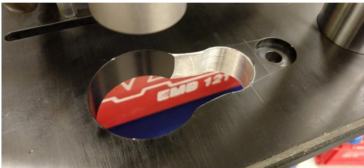
Figur 5-8 Uppborrat hål för att få plats med den nya lägesgivaren. Författarens egen bild.
