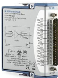
Figur 2-9: Ett NI 9264 kort, (National instruments, u.d-i). Återgiven med tillstånd.
