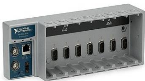
Figur 2-5: Ett NI cDAQ-9188 dockningsstation (National Instruments, u.d-c). Återgiven med tillstånd.
