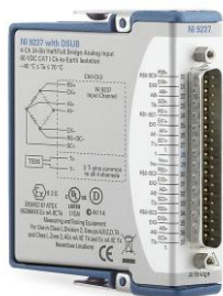
Figur 2-8: Ett NI 9237 kort, (National Instruments, u.d-g). Återgiven med tillstånd.
