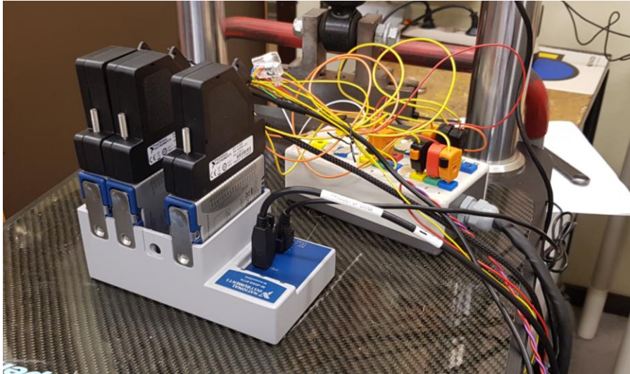
Figur 5-3 Uppkoppling av modulerna NI 9207, NI 9237, NI 9264, NI cDAQ-9174 och DSUB:en mot testtriggen. Författarens egen bild.
