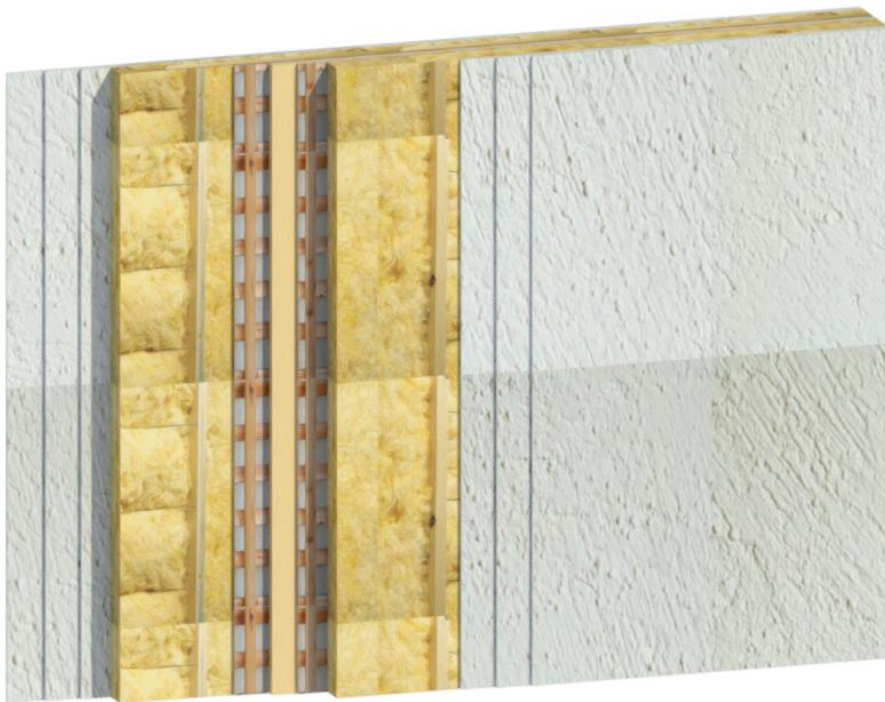
Figur 3.8 Skikten och beståndsdelarna av en lägenhetsskiljande vägg för byggnad 1. Lägenhetsskiljandevägg: Uppbyggnaden av den lägenhetsskiljande väggen består av en gipsskiva, två stycken
