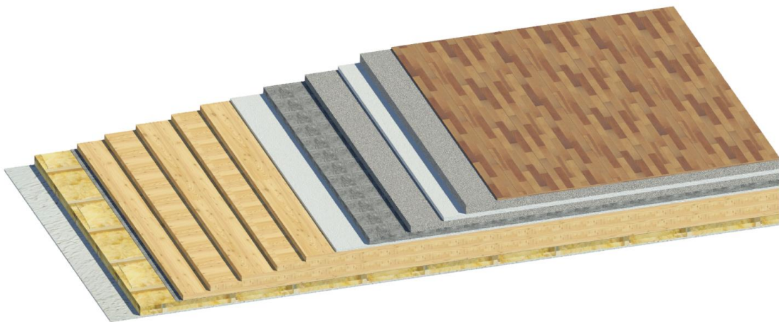
Figur 3.12 Skikten och beståndsdelarna av bjälklaget för byggnad 2.
