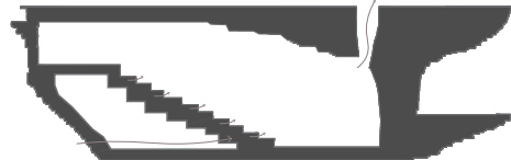
Luften tas in igenom sprickor mellan skifferskikt under sittläktare.
