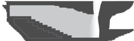
Insläppning av naturligt ljus till konsertsalen från taköppningen
