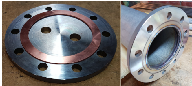
Figur 1.3: Till vänster: överfläns inklusive kopparpackning. De två hålen i mitten är till för bränsleinmatningssystem och gasutflödesrör. Till höger: underfläns fastsvetsad på förgasarkammarens topp. Vid montering sätts under- och överfläns ihop med bultar genom de tio hålen i ytterkant. Återgiven med tillstånd [13].
