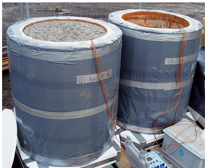
Figur 2: Välisolerade betongblock gjutna på arbetsplats, med Anläggning FA (samma betong som i fundamentet) respektive Anläggningscement.
