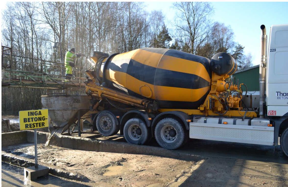
Figur 2. Rengöring av rotertrumma i Kungälvs restbetongshantering. (Isaksson, Nilsson, 2016).
