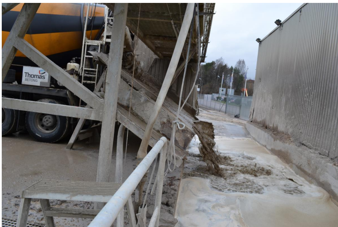
Figur 5. Tömning i den första sedimentbassängen. (Isaksson, Nilsson, 2016).
