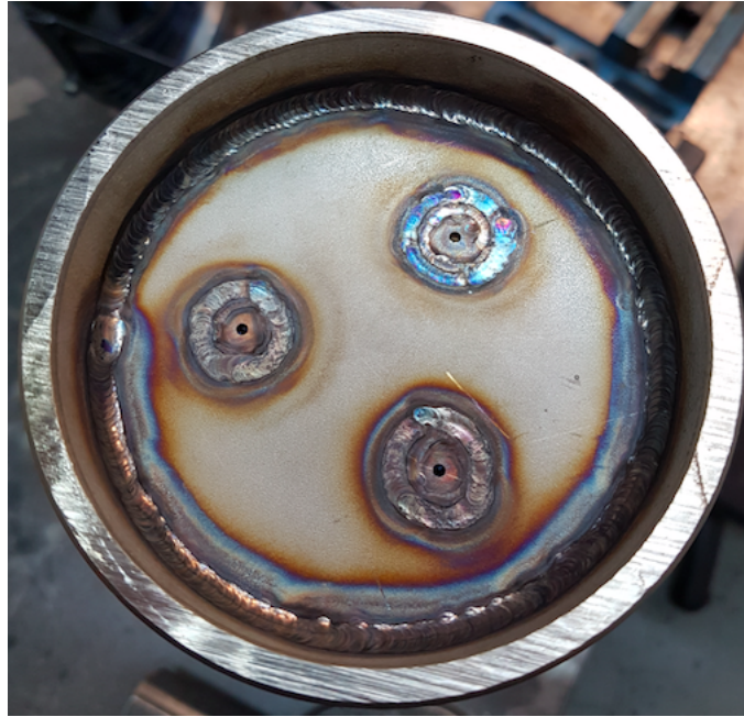
Figur 44: Insatsen monterad i reaktorröret.
