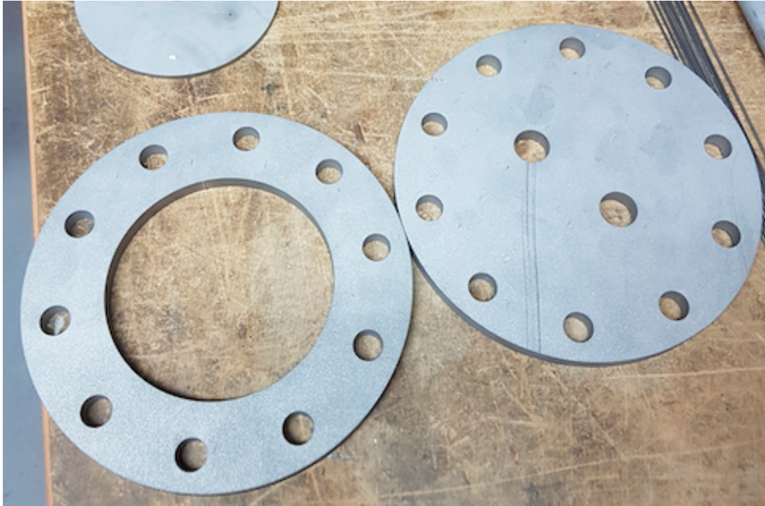
Figur 39: Över- och underfläns skurna med vattenskarare.
