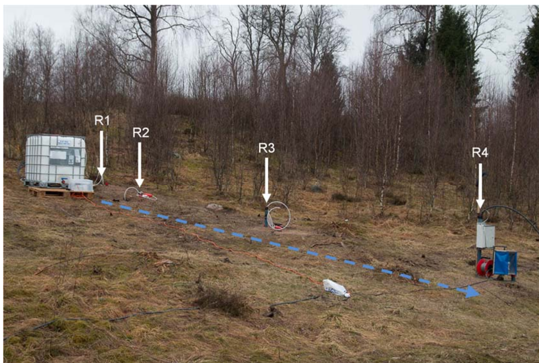
Figur 4.7 Försökuppställning med fyra grundvattenrör (R1-R4) för tillsättning av spårämne (R1), övervakning och provtagning för analys samt kontinuerlig pumpning (R4). Den blå streckade linjen beskriver förväntad naturlig strömningsriktning för grundvattnet.
