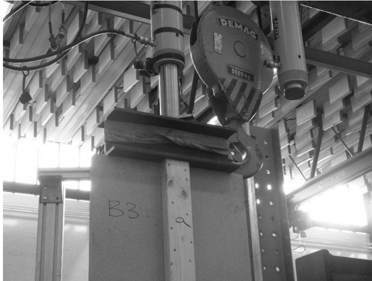
Figur 5.5. Uppställning överkant, domkraft samt I-balk som lastfördelare
