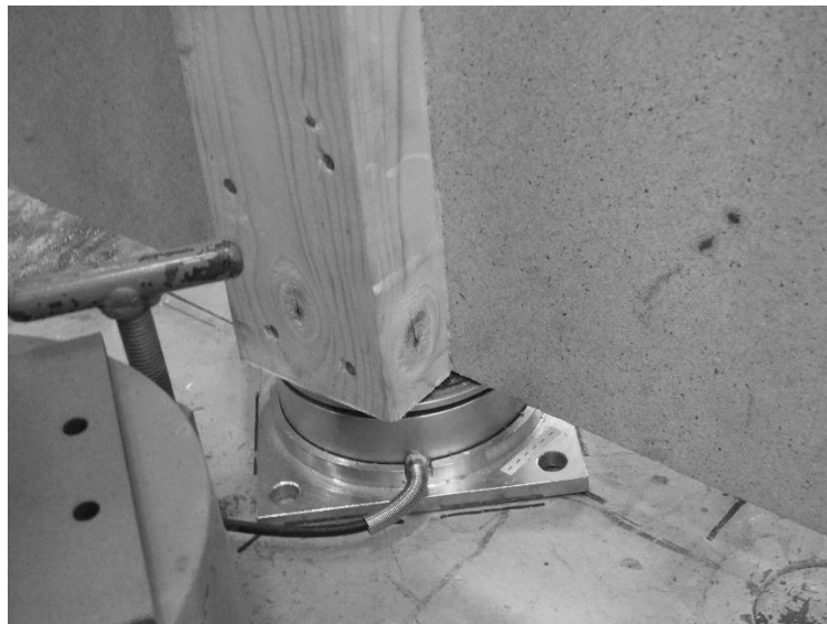
Figur 5.6. Uppställning på lastcell, underkant.
