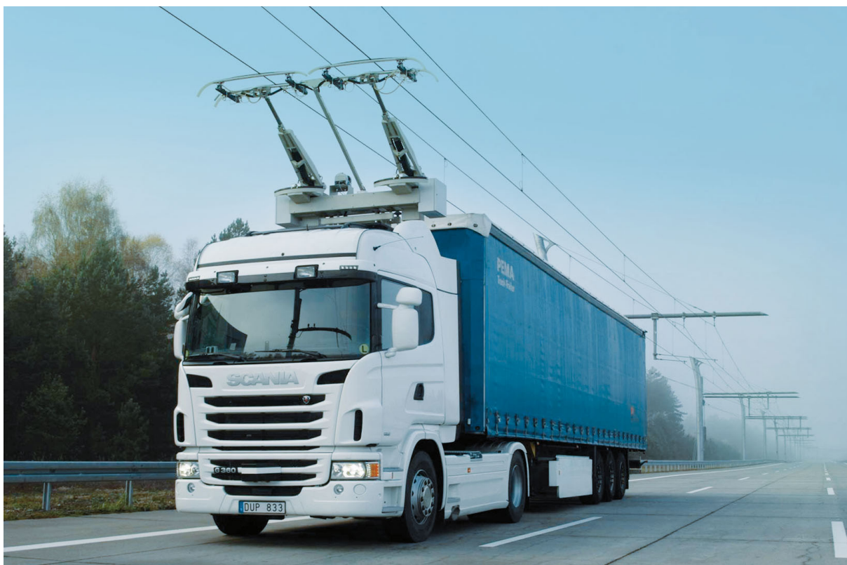
Figur 2.1 Siemens och Scania samarbetar för att utveckla lösningar för framtidens godstransport på landsväg, så kallade elvägar. Bilden är från Siemens testbana för eHighway utanför Berlin. (Källa: Scania)
