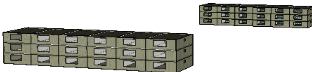
Figur 7.4 ”Modellbaserad styrning genom återspeglings” med två identiska byggnader. ”Spegelbyggnaden” styr värmeregleringen i referensbyggnaden. Översiktsbild av simuleringsmodellerna i IDA ICE.
