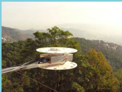
En GNSS-installation för mätning av vegetation och markfuktighet.
