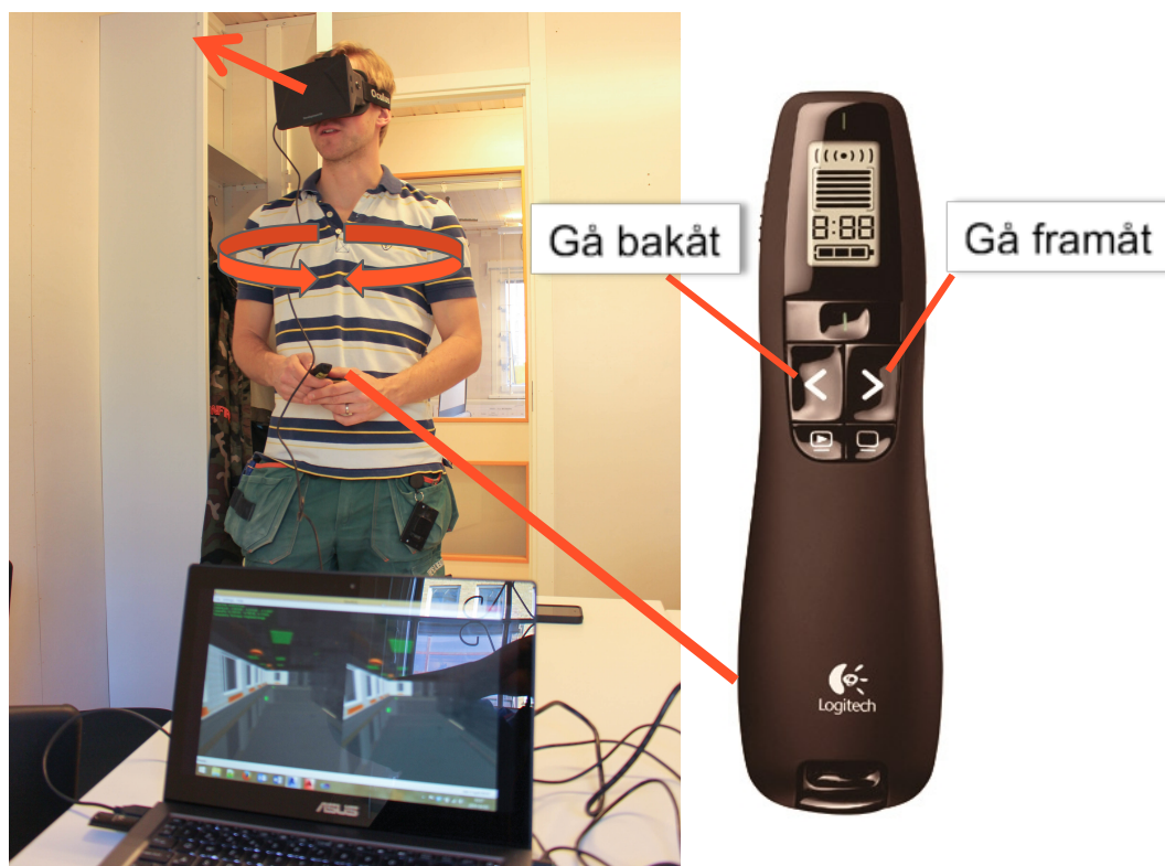
Figur 10. Navigeringen i modellen realiserades genom att användaren trycker på framåt- resp. bakåt-knappen för att röra sig fram eller bak i modellen, samtidigt som riktningen bestäms av det håll som man för tillfället tittar åt.
