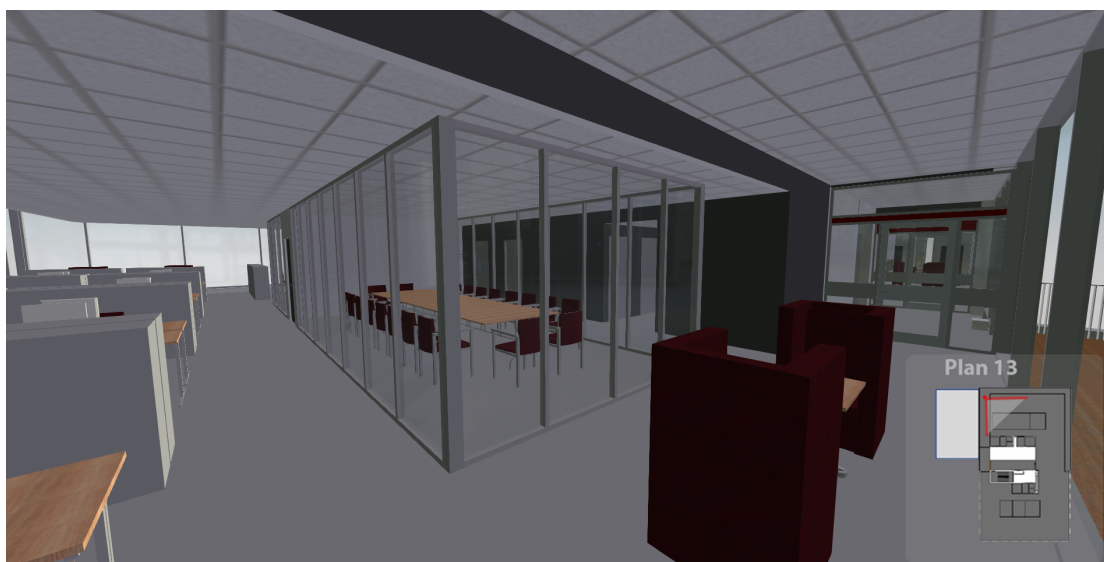
Figur 3. I högra hörnet av bilden finns en illustration på hur orienteringskarta kan integreras in i 3D-vyn i BIM-viewern.
