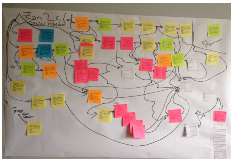
Figur 1. Strukturplan som är resultatet efter strukturplansworkshopen. Olika färgerna på post-it lapparna används för att färgkoda olika yrkesgruppernas aktiviteter.
