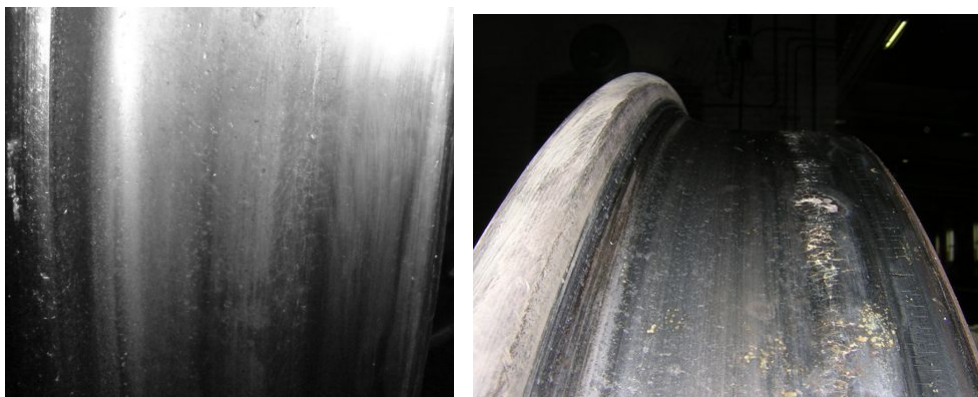
Figur 3. Exempel på låg (vänster) och hög (höger) skadenivå hos utmattningssprickor (ytinitierad rullkontaktutmattning) i zon 1.
