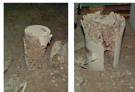
3. attēls. Cilindri pēc spiedes sabrukuma. Kreisais attēls ar berzi (slogotā cilindra virsma bez plaisām, jo ir berzes saturēta), labais – ar dubultām teflona plātnēm, kuras novērš berzi (slogotā virsma izjukusi, jo nav berzes saturēta) [3].
