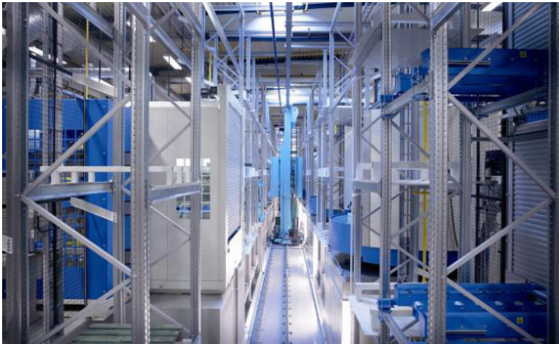
Figur 1: Multitaskcellen på GKN Aerospace är en så kallad "flexible job shop". I cellen finns lagerplatser och portar till de bearbetande resurserna. Alla transporter sker med hjälp av en transportkran. Produkterna kommer in i cellen från höger i bilden.
