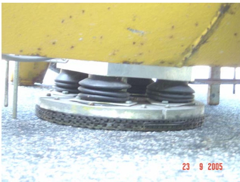
Figur 6 Belastningsplatta på en KUAB FWD.
