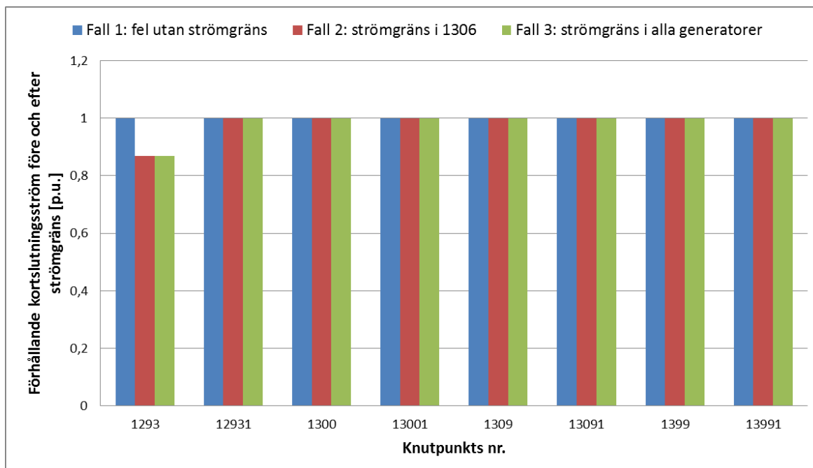
Figur 4.2: Förhållandet mellan kortslutningsström före och efter strömgräns för ett antal knutpunkter.
