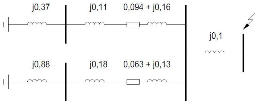
Figur 9.2: Enlinjeschema med framräknade impedanser i p.u.
