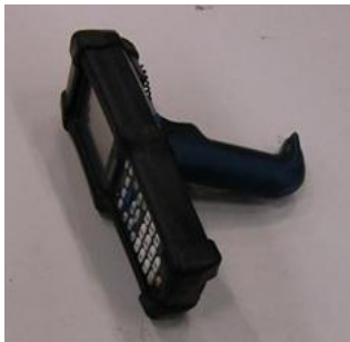
Figur 26. RF-scanner som används för att scanna plocklista, artikelnummer och streckkoder.
