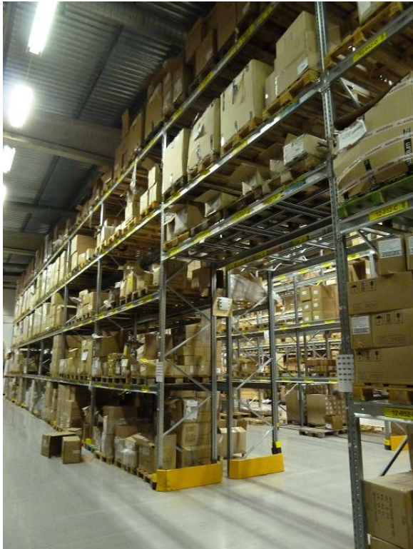
Figur 18. Transportgång i mitten av ställagen för truck.
