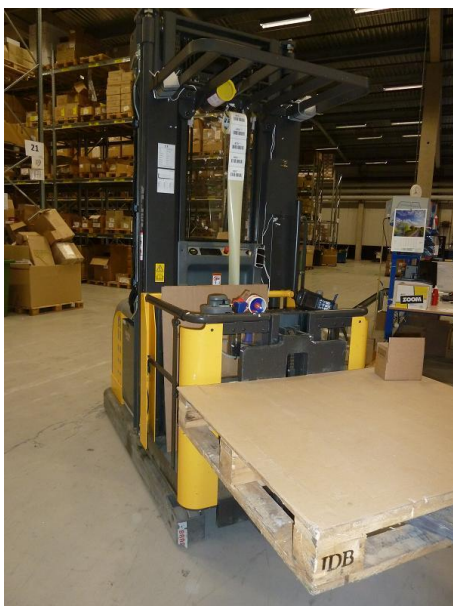
Figur 25. Bild på trucken och en liten kartong längst fram. De klisterlappar med RFID-nummer som hänger på trucken är de som klistras på varje kartong för att artiklarna som plockas ska allokeras till den kartongen.
