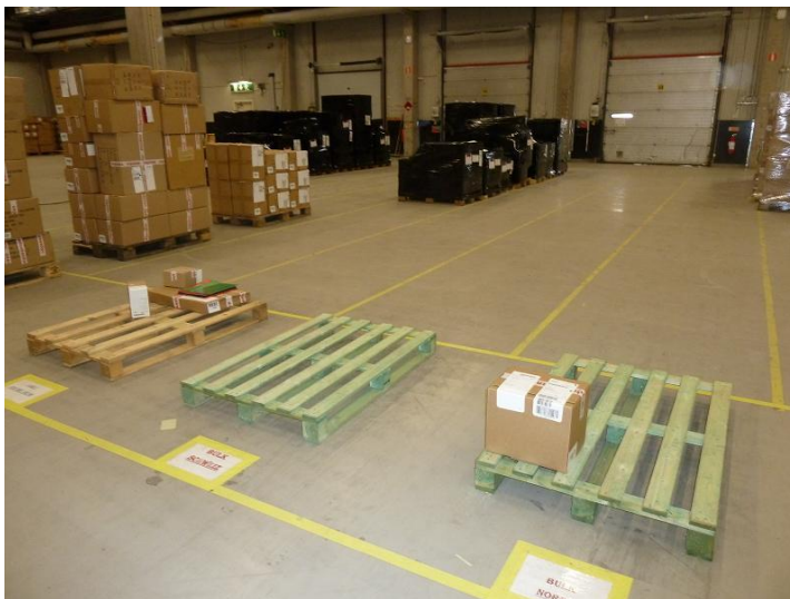
Figur 28. Här ställs enskilda paket. Framför varje EUR-pall finns en beskrivning med vilket transportbolag paket ska transporteras med. I bakgrunden ses större försändelser, staplade och inplastade.
