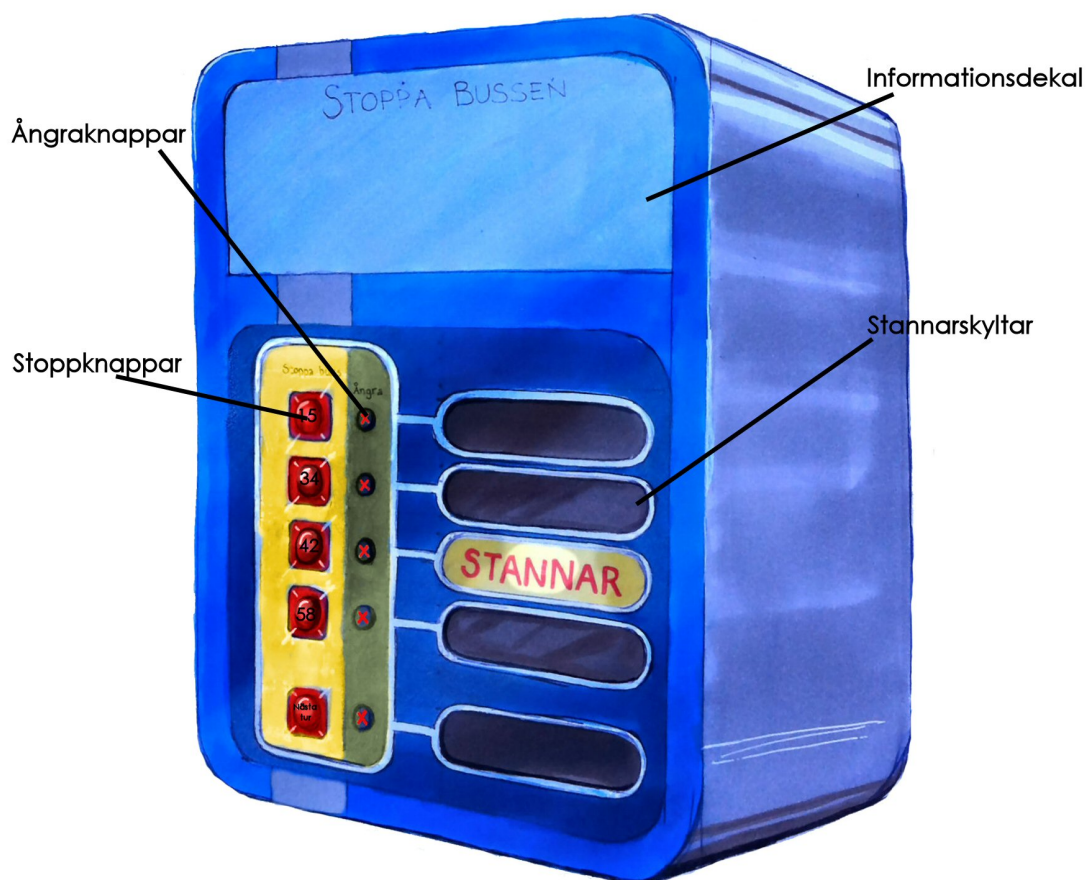
Figur 4.2 Skiss av prototypens användarpanel. Här visas de olika knapparna, skyltar och informationsdekal som finns på produkten.
