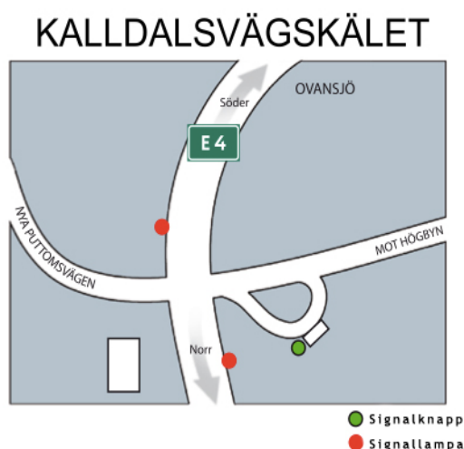
Figur 2.5: Figuren visar en befintlig lösning där det finns en signalknapp (grön prick) på hållplats som tänds en signallampa (röd prick) ute på E4:an.
