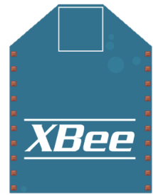
Figur 4.7 Radioenheten XBee, den skickar och tar emot information
