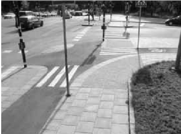
Figure 4.7. Zebra crossing over the bicycle lane. (Source: Sveriges Kommuner och Landsting, p.107, 2010)
