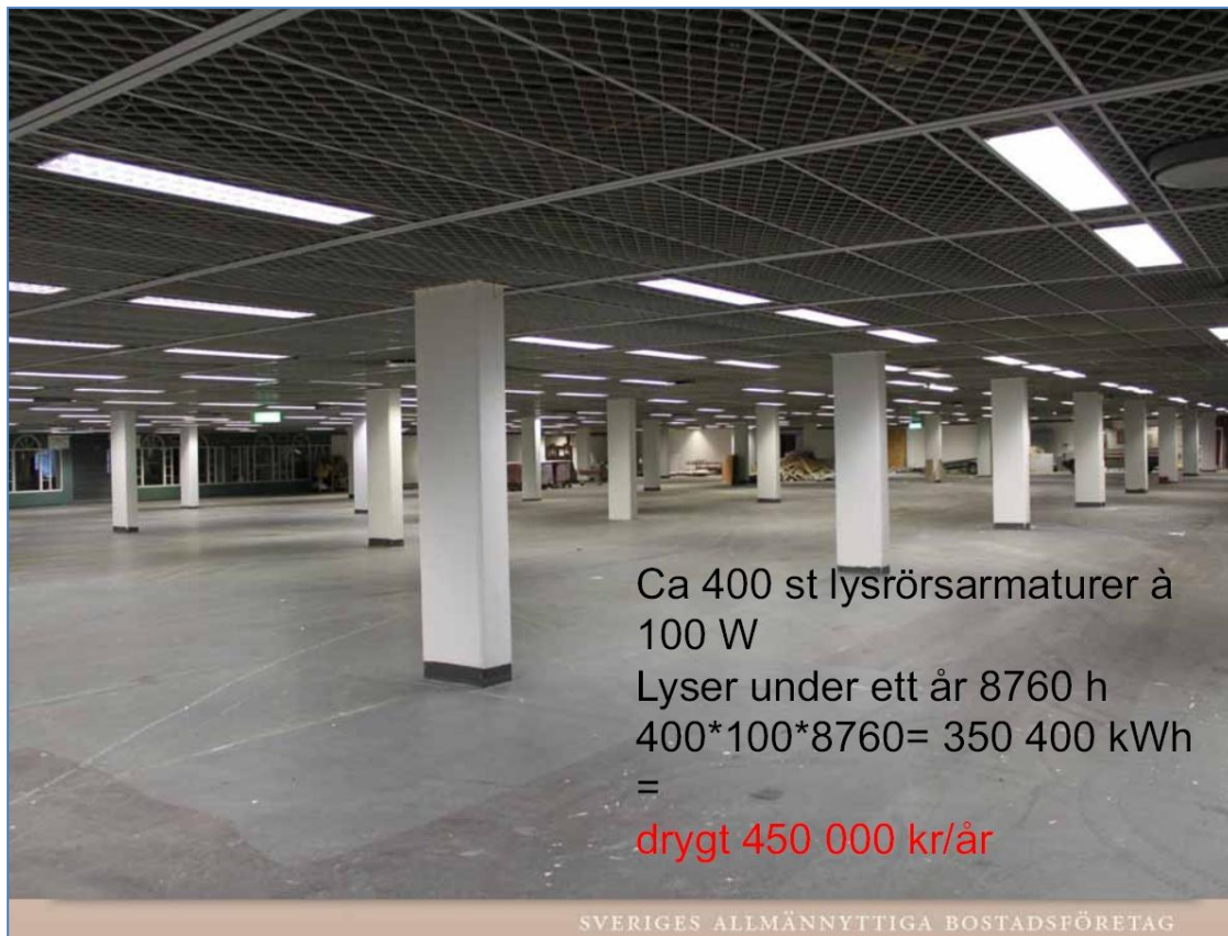
Figur 4. Vart tar energin vägen? "Bortglömda utrymmen" (Therese Rydstedt, SABO)
