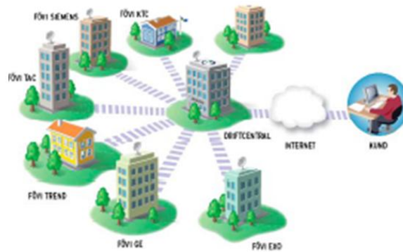
Figur 6. FÖVI – Fastighetsövervakning via internet är ett exempel på IT-baserade energitjänster som utvecklats på Göteborg Energi (Dennis Jonsson, Göteborg Energi).
