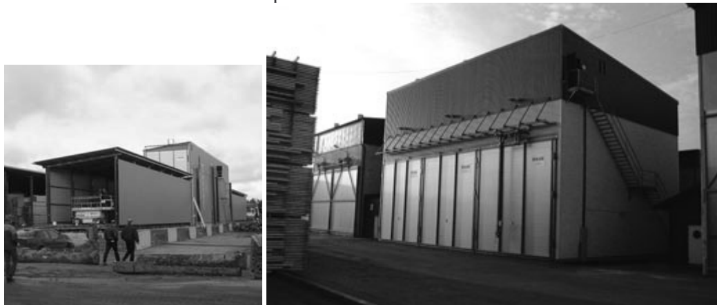
Figur 2 & 3 Exempel på kanaltork och kammartork (bilder från WSAB)
