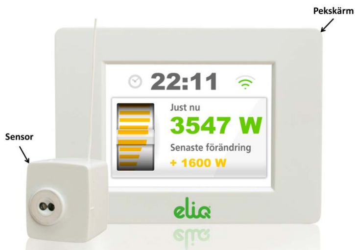
Figur 4. Eliq trådlös sändare som kommunicerar med pekskärmsdisplay (3,5 tum) som här visar realtidsinformation.
