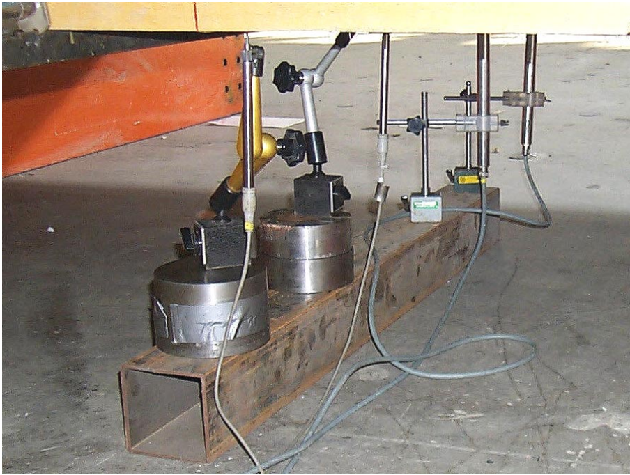
Figur 2.7 Placering av lägesgivare för mätning av nedböjning, foto Lars Wahlström.
