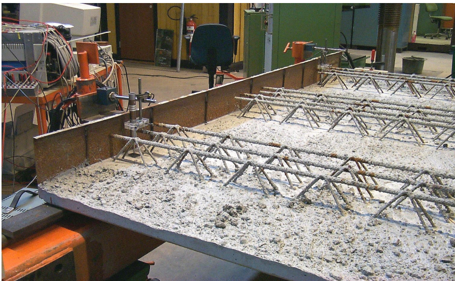
Figur 2.8 Placering av lägesgivare för mätning av stödsättning, foto Lars Wahlström.
