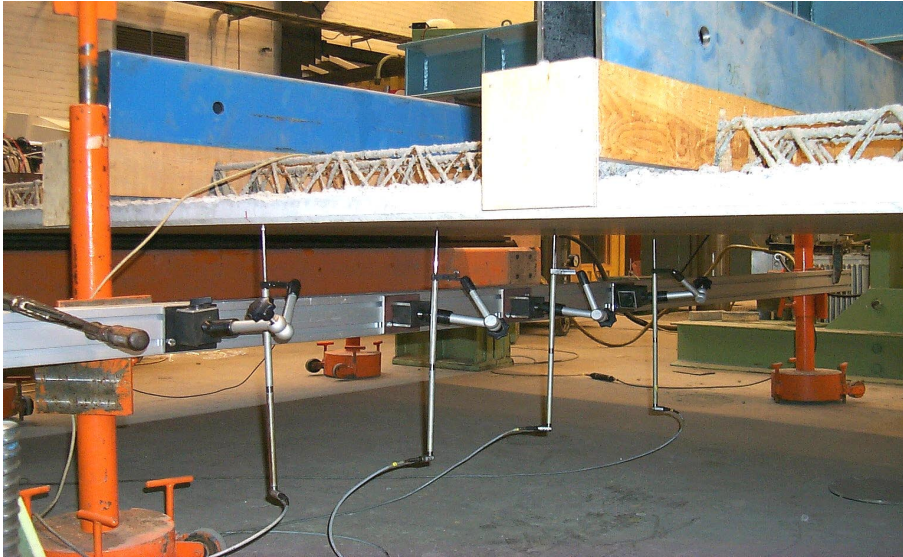
Figur 2.9 Placering av lägesgivare för mätning av mittnedböjning, foto Lars Wahlström.
