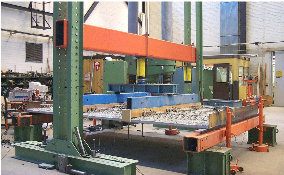
Figur 2.6 Försöksupställning vid domkraftsbelastning, foto Lars Wahlström.
