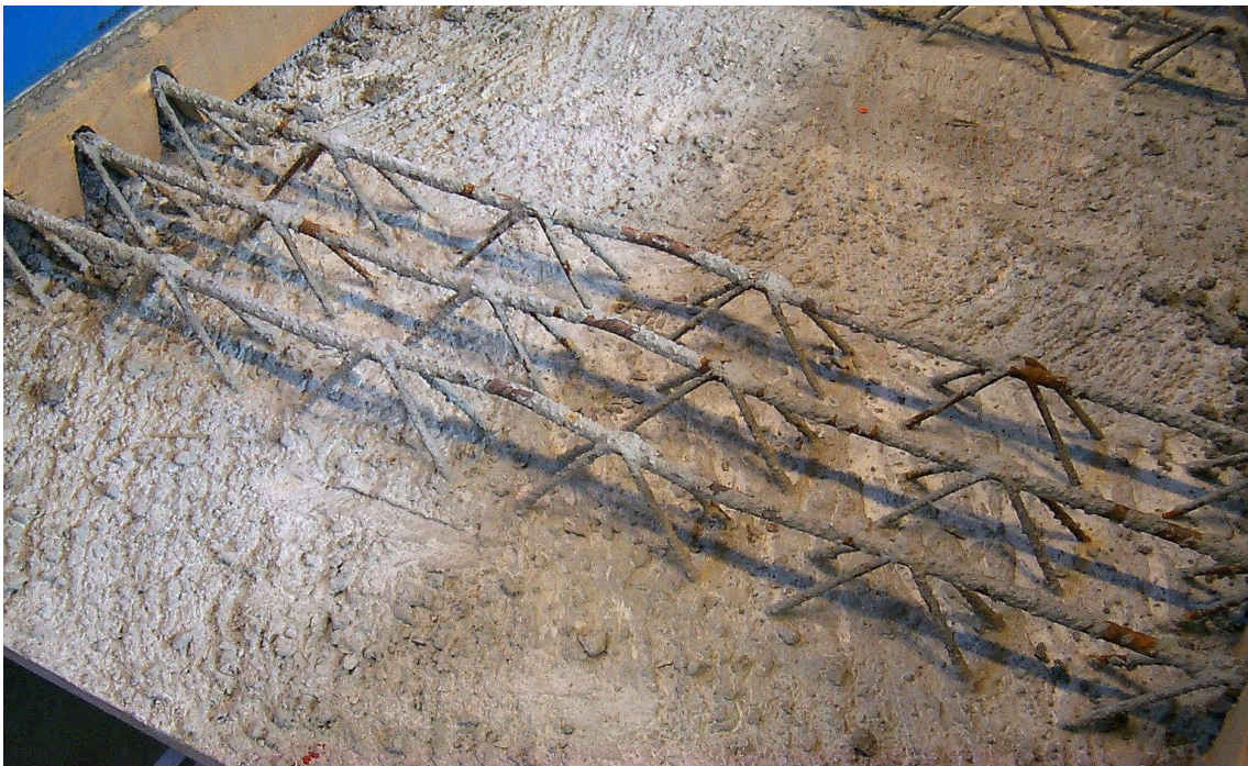
Figur 3.8 Bild på överkantsstänger som har knäckt, foto Lars Wahlström.
