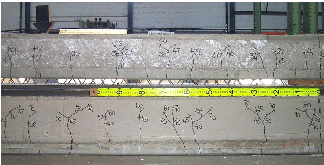
Figur 17. Sprickbild för elementen mellan linjelast och centrumlinjen, den övre bilden visar plattan med 200 mm tjocklek och den undre 250 mm tjocklek. Siffrorna indikerar sprickans läge vid belastningen Q , [kN].
