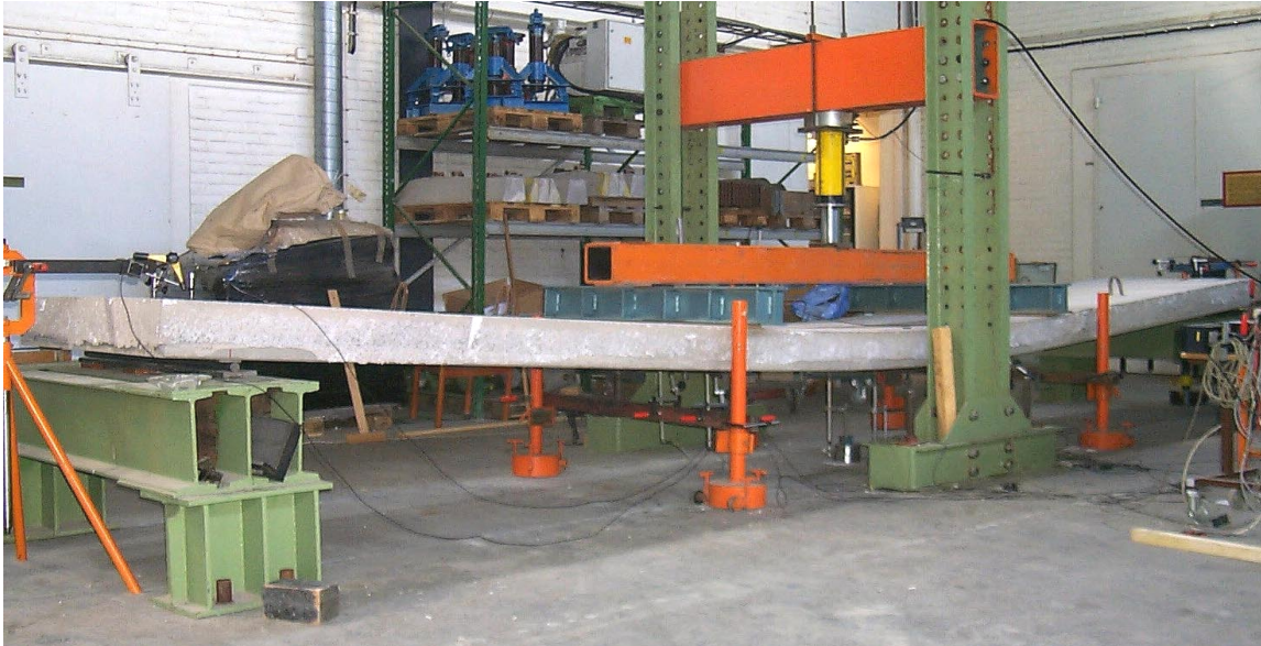
Figur 16. Nedböjning innan avlastning för elementet med tjockleken 200 mm.
