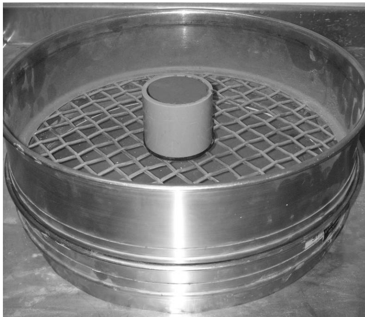
Figur 7.2: Lerprov placerat på 16 mm siktgaller.
