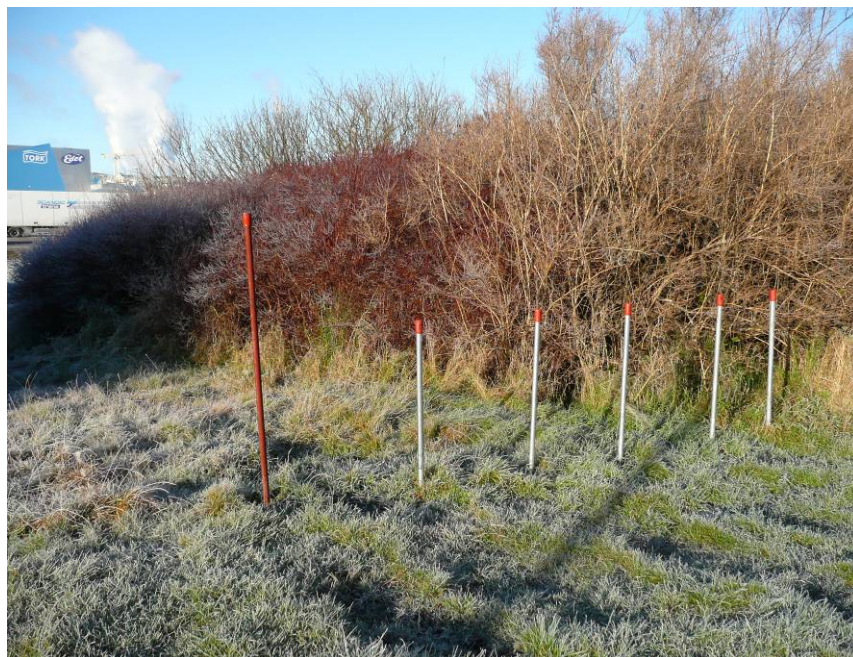
Figur 5.2 Borrhål 8SGI där fem stycken porttrycksmätare och ett grundvattenrör har installerats.
