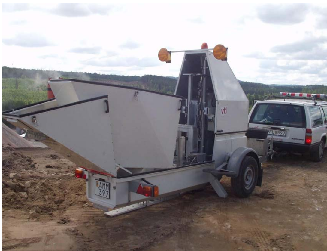
Figur 8-4 Dragbil och vagn med tung fallviktsutrustning från VTI
