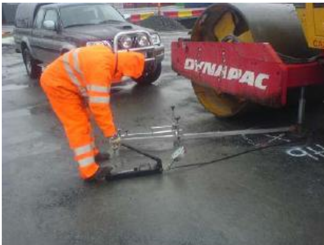
Figur 4-1 Plattbelastningsutrustning med deformationsmätare (Rosengren, Senohradski, 2007)
