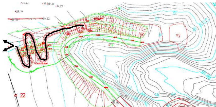
Figur 2:3. Lakvattnet från avfallsmassorna leds via flera sedimenteringsdammar ut i recipienten. (Ramböll, 2005)
