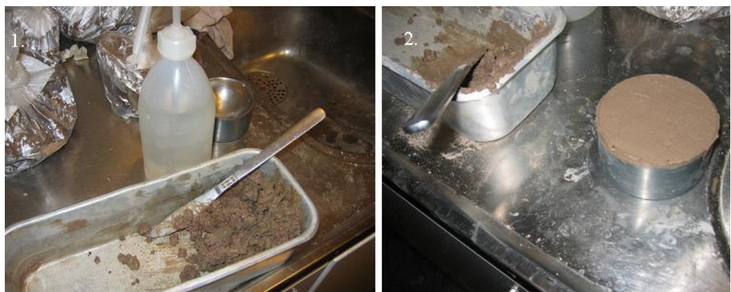
Figur 28 Finfördelning och tillsättning av vatten (bild 1). Blandning till en homogen massa i blandningsskålen samt avjämning (bild 2).
