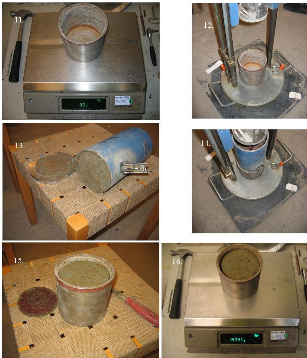
Figur 24 Nollställning av cylinder för uttryckning av provkropp (bild 11). Placering av cylindern på MCV-apparatens bottenplatta (bild 12). Frigörning av bottenplattan på provcylindern (bild 13). Placering av provcylindern på cylindern för uttryckning (bild 14). Borttagning av fiberplattan på provkroppen (bild 15). Invägning av provkroppen efter försök (bild 16).
