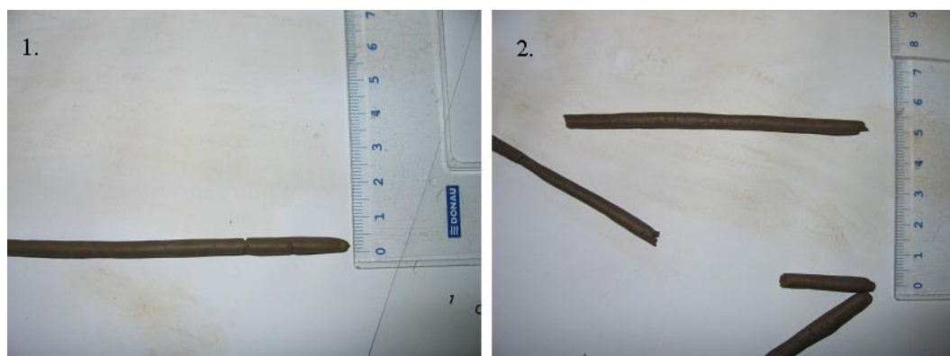
Figur 31 Utrullning till en 3 mm tjock tråd (bild 1). Söndersprucket prov vid utrullning (bild 2).
