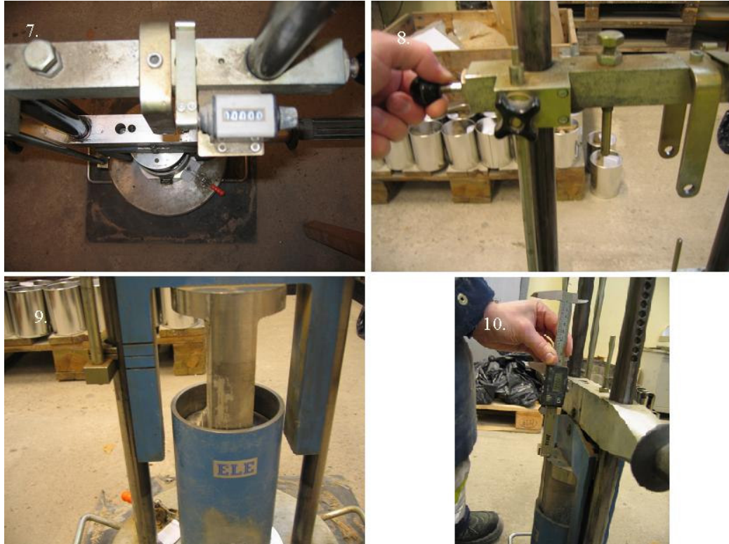
Figur 23 Nollställning av räkneverk (bild 7). Justering av fallhöjd (bild 8-9). Avläsning av nedtryckning (bild 10).
