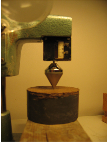
Figur 29 Tangering av 60g - 60° -konen med provet.
