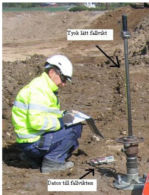
Figur 18 Tysk lätt fallvikt med inkopplad fältdator.
