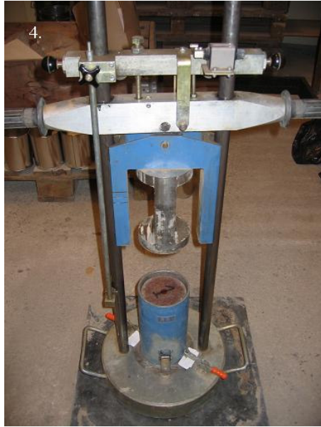
Figur 21 Inspänning av provcylindern samt placering av fiberplattan.
