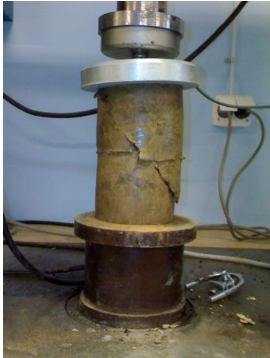
Figur 27 Brott på MCV-provkroppen.
