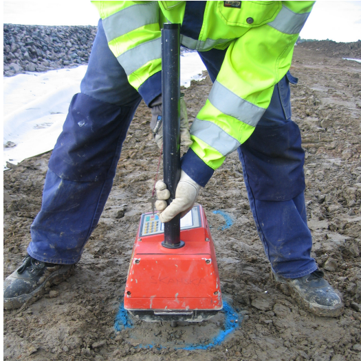
Figur 17 Nedförning av strålkällan.
