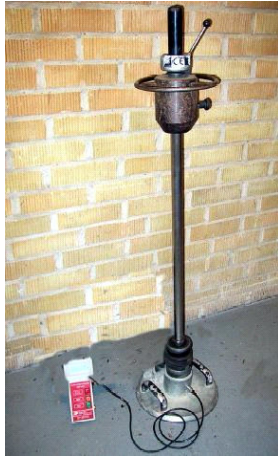
Figur 13 Lätt fallviktsmätare, tysk modell. ( Berggren 2004)
