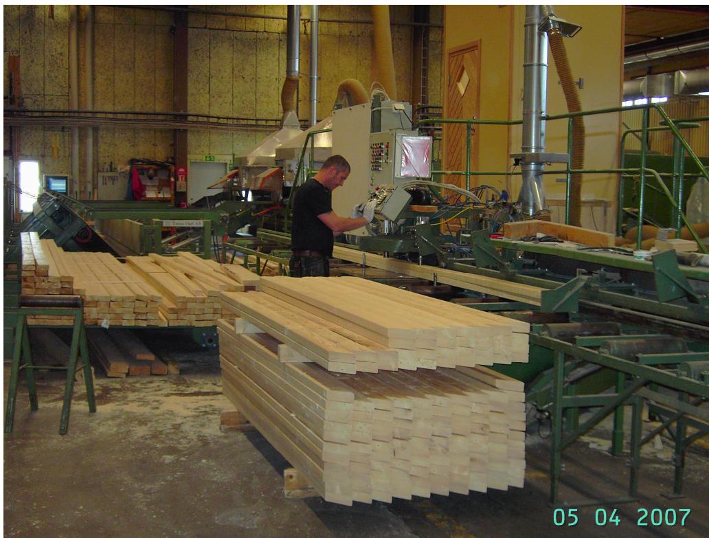
Figur 4.2 Kapning av virke.
