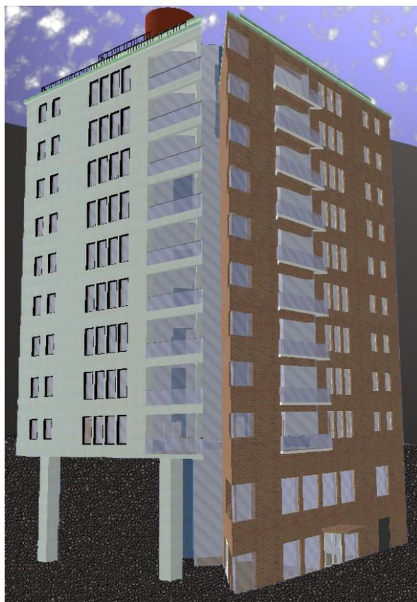
Figur 6.9 Byggnadsförslag, huset är uppdelat i två halvor, en i tegel och en i betong
