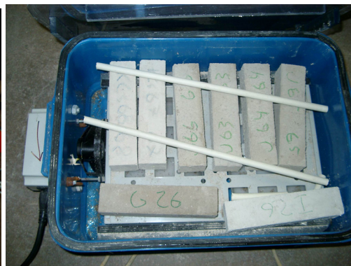
Figur 3.11. Klimatbox med 75 % RF i 10°C. Från sidan cirkuleras luften via en fläkt (Ludvigsson, 2004).
