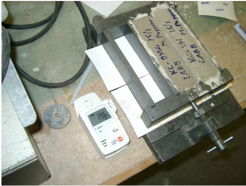
Figur 3.6. Isärtagbara stålformor där gjutning av provprismor 40x40x160mm äger rum. (Ludvigsson, 2004).
