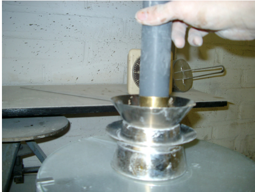
Figur 3.15. Konen fylldes med bruk som komprimerades genom stötar med en cirkulär stöt, (standardutrustning) (Ludvigsson, 2004).
