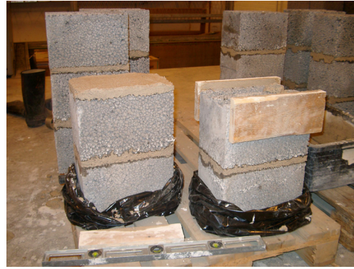
Figur 3.28. Murning av pelare med D-bruk där hela fogen fylldes med 15 mm bruk. Plastsäcken dras över pelaren och tillsluts (Ludvigsson, 2004).
