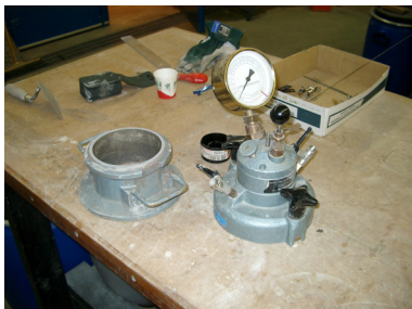
Figur 3.12. Lufthaltmätare för bruk enligt tryckmetod (se ovan). (Ludvigsson, 2004).
