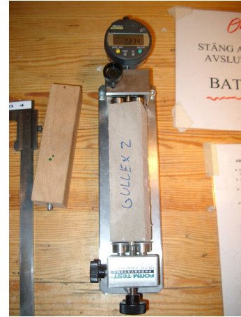
Figur 3.22. Mätutrustning för uttorkningskrympning. Före varje mätning kalibreras utrustningen med en kalibreringsprisma (Ludvigsson, 2004).
