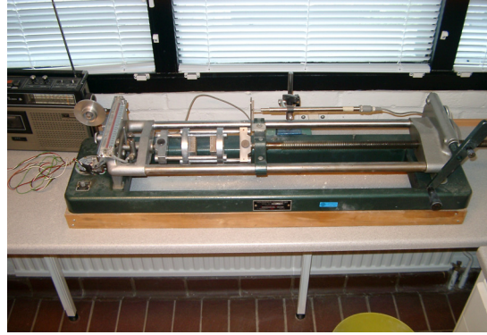
Figur 3.18. Tensometer där tryckproven utfördes. Tillhöger i bild sker manuell vevning som skruvar en gängad stång till tryck vid tryckbackarna (Ludvigsson, 2004).
