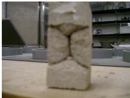
Figur 6.1. Typisk brottbild för en provprisma vid tryckprovning (Ludvigsson, 2004)
