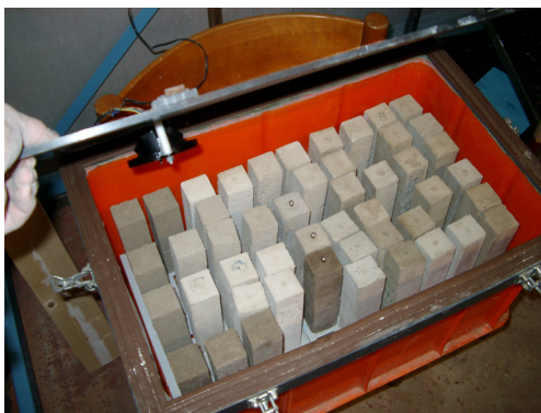
Figur 3.10. Klimatbox med 75 % RF som placerades i 20 respektive 4°C. På locket finns en fläkt som cirkulerar luften. Saltet finns på botten under ett galler (Ludvigsson, 2004).
