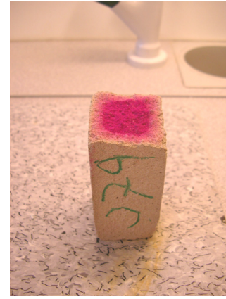
Figur 3.25. Exempel på hur svårt det kan vara att bestämma en tydlig karbonatiserad front (Ludvigsson, 2004).
