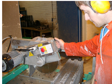
Figur 3.26. Blocken delades med en vattenkyld cirkelsåg. Blocken torkade därefter i rumsklimatet (Ludvigsson, 2004)
