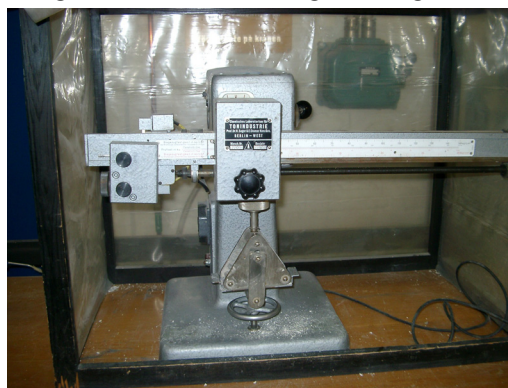
Figur 3.21. Böjdragprovutrustning som användes (Ludvigsson, 2004).
