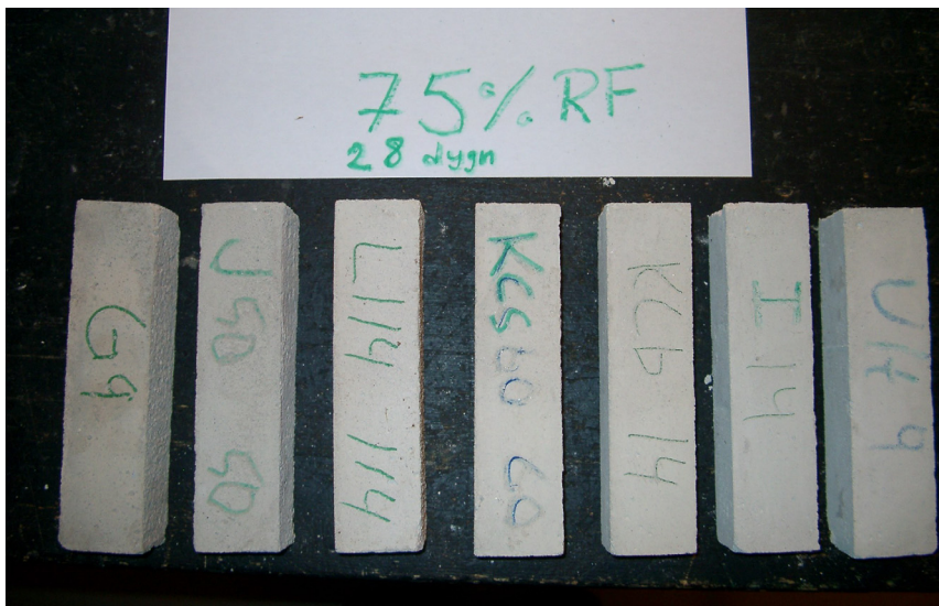
Bild 6.9. Bruksprismor i klimatet 20°C, 75 % RF efter 28 dygn. Från vänster går det från mörkare grå till ljusare gråton. Blixt inverkar något på hur bilden representerar verkligheten (Ludvigsson, 2004).
