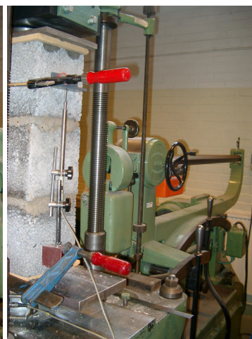
Figur 3.30. Alfamaskinen med hjälp av hävstångsprincip trycker pelaren. Mätutrusning är placerad på murpelaren (Ludvigsson, 2004).
