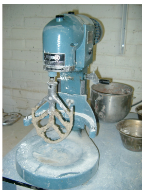
Figur 3.4. Standardblandare för laboratieförsök som användes vid inledande brukstester (Ludvigsson, 2004).
