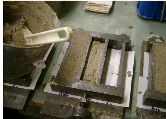
Figur 3.7. Stålformen fylldes upp till hälften, komprimeras, och därefter toppfylldes. Läskpapper är placerat under stålramen. Läskpapper placeras även ovanpå efter påfyllningen (Ludvigsson, 2004).
