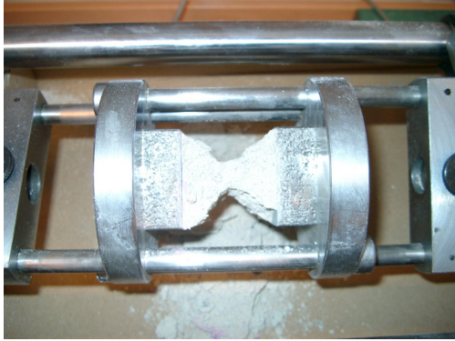
Figur 3.17. Pågående tryckprovning med tensometern. Här överförs dragkraft till tryck på prismet (Ludvigsson, 2004).
