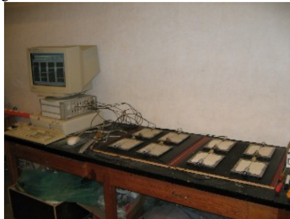
Figur 3.22. Mätutrustning för uttorkningskrympning. Före varje mätning kalibreras utrustningen med en kalibreringsprisma (Ludvigsson, 2004).
