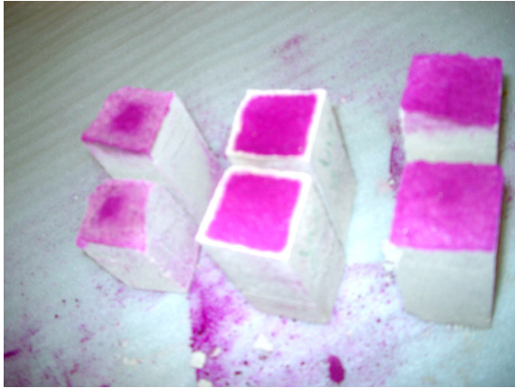
Figur 3.24. Provprismorna i mitten uppvisar en tydlig karbonatiserad front. Prismorna till höger har inte blivit karbonatiserade, dessa uppvisar en serisröd färg över hela brottytan (Ludvigsson, 2004).
