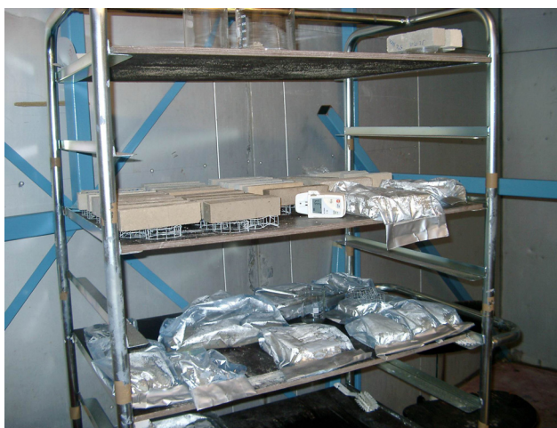
Figur 3.9. Klimatet 4°C i ett ventilerat klimatrum. Här placerades provprismorna öppet, i klimatboxar med 75 % RF och i tätslutna plastpåsar (100 % RF) (Ludvigsson, 2004).
