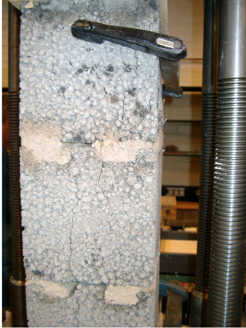
Bild 6.7. Tidig sprickutveckling, vid 28 dygnprov (Ludvigsson, 2004).
