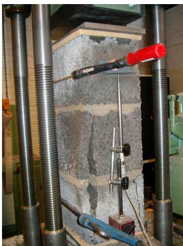
Figur 3.29. Mätutrusning sitter på plats trots att brott sker vid provtryckning (Ludvigsson, 2004).
