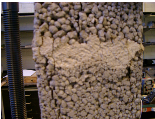
Bild 6.1. Brottsutveckling av en Jurapelare (J 12) vid 28 dygn. Bild 6.1 visar hur brottet inleds med sprickor vid fogarna, längs ytterkanterna. Det knäpper i blocken innan sprickorna visar sig, vilket tyder på att blocken har nått sin brottgräns. Själva brottet sker momentant, men inte så explosivt som för de pelarna som murades med B-bruk (Ludvigsson, 2004).
