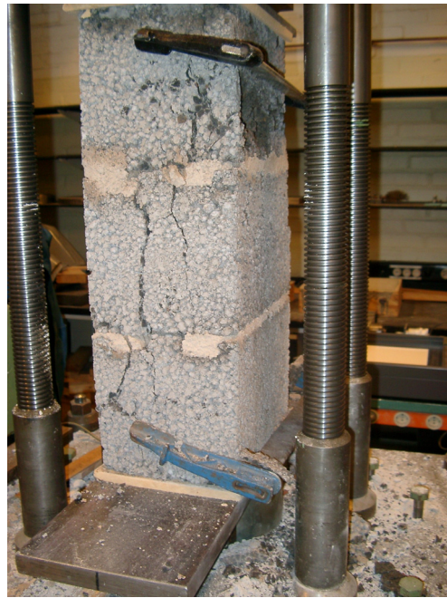
Bild 6.8. Mer utvecklade sprickor från samma pelare som föregående bild (Ludvigsson, 2004).
