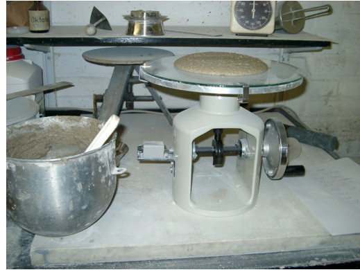
Figur 3.16. Konsistensen på bruket mättes genom att mäta den utbredning brukskonen får efter 10 stötar med stötbordet. (Ludvigsson, 2004).
