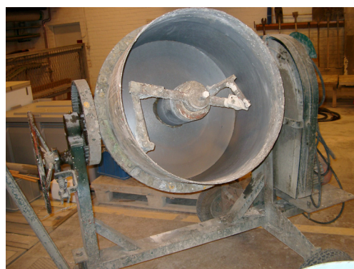
Figur 3.5. Tvångsblandaren användes till bruksblandningarna för provningen (Ludvigsson, 2004).
