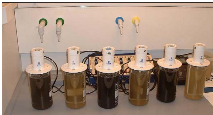
Bild 10. Körning av de sex burkarna. I burk 1, 3 och 5 är sulfidhalten hög vilket förklarar den mörka färgen på vattnet.
