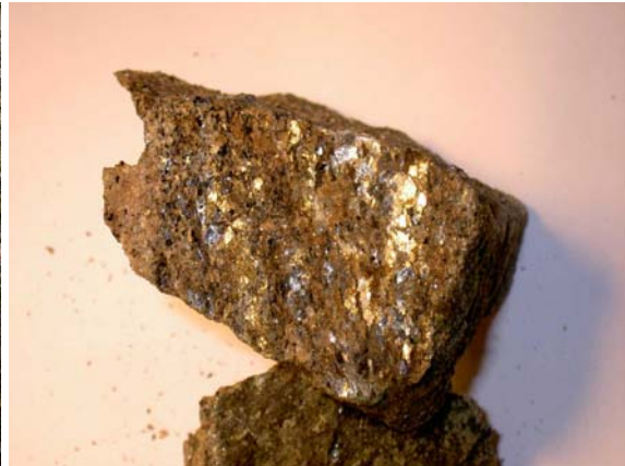
Figur 3.29, Bergets förgnejsade struktur. Figur 3.30, Muskovit i brottytan.
