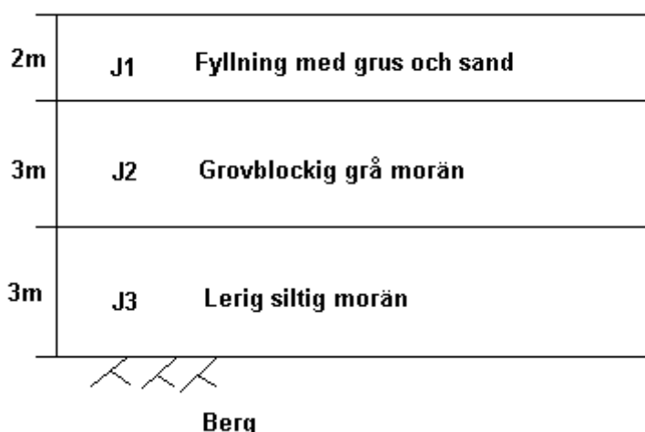
Figur 4.25, Schematisk skiss av jordlagerföljden på Inlandsön.
