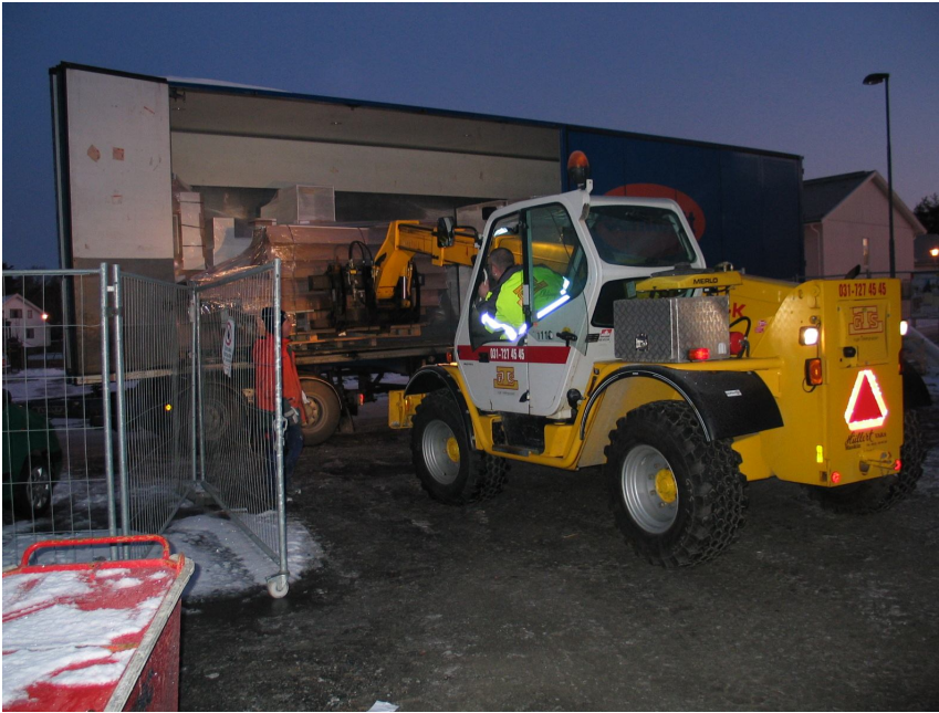
Bild 2.1.1. Teleskoptrucken lyfter pallarna ut ur lastbilen.
