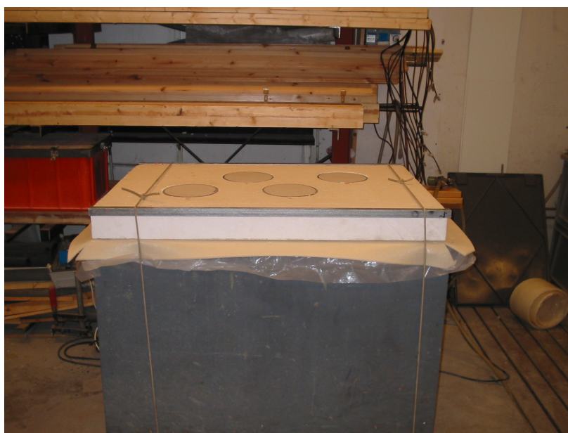
Figur 6.4. Fotografi av värmelådan sett från sidan.
