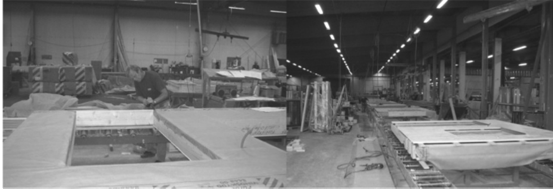
Figur 4.13-4.14 Produktion av väggelement med "linesystem". Den vänstra bilden (4.13) visar produktion vid en station utefter "linesystemet". Bilden till höger (4.14) är en överblicksbild över anläggningen
