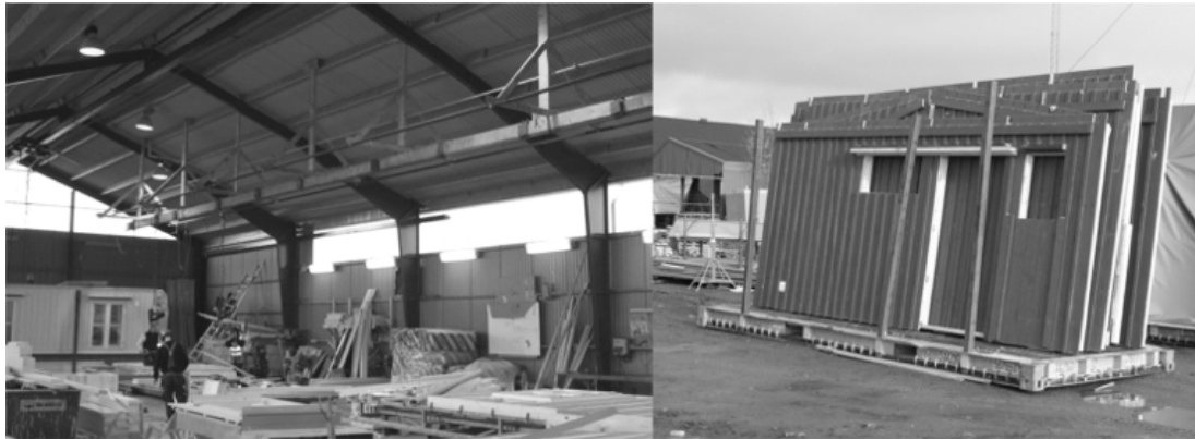
Figur 4.4-4.5 Produktion i Fältfabrik 1, bilden till vänster (4.4) en översiktsbild av lokal för väggelementstillverkning. Högra bilden (4.5) visar väggställ med väggelement innan täckning och leverans till monteringsplats.
