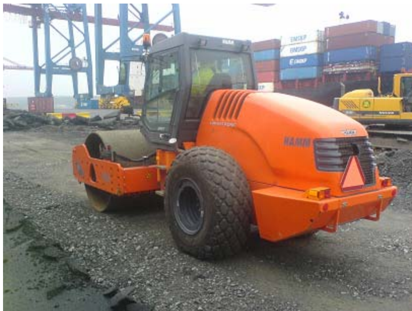
Figur 3.3 Hammvälten som användes vid examensarbetet.
