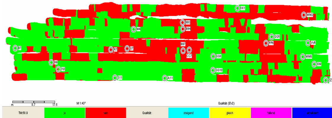
Figur 5.5 Etappens uppdelning då kravet på bärighet har fastställts. Den rödfärgade delen av ytan uppfyller inte bärighetskravet.
