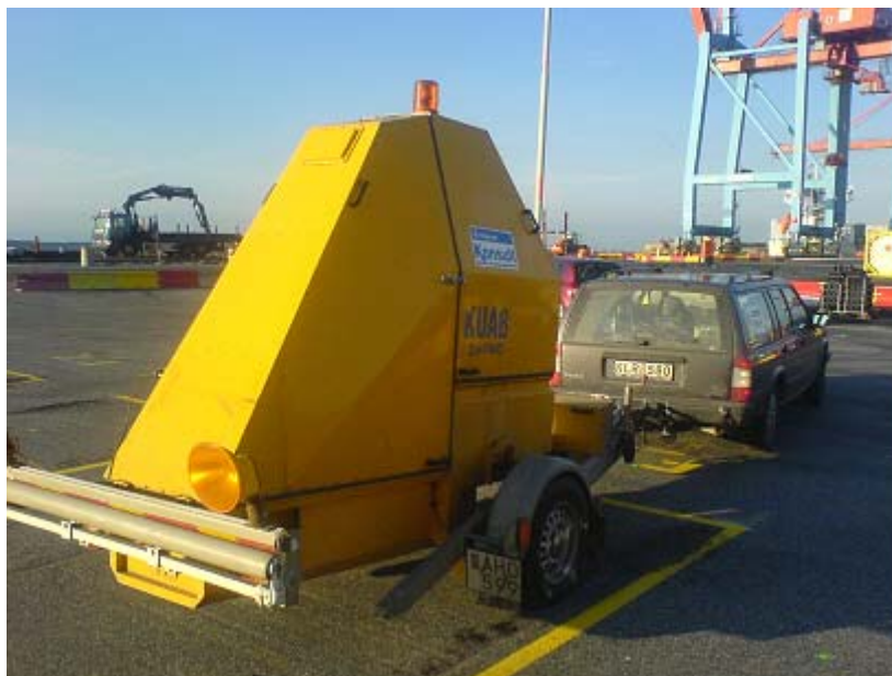
Figur 3.2 Tunga fallvikten som användes vid examensarbetet.
