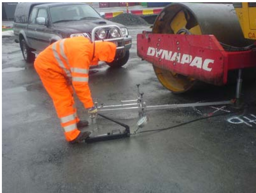
Figur 3.5 Statisk plattbelastningsförsök med Dynapacvälten som motvikt.
