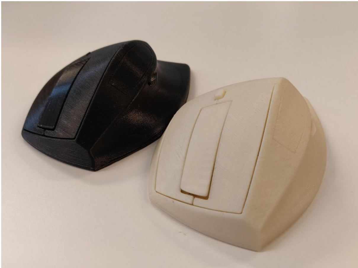
Figur 30. Utskrivna prototyper varav den högra har integrerad elektronik. Den svarta modellen till vänster är utskriven i PLA-plast och den vita modellen till höger är utskriven i ABS-plast. Författarens egen bild.
