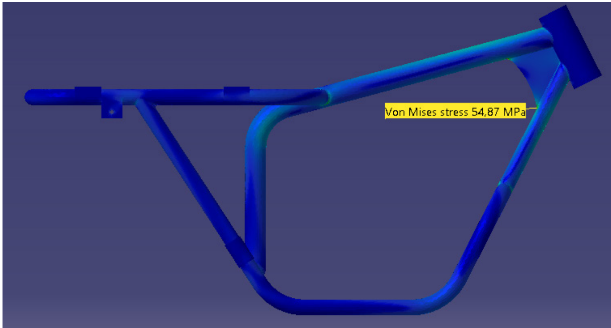
Figur 20. Spänningar hos den första iterationen av den förstärkta ramen vid maximal acceleration. Författarens egna bild.
