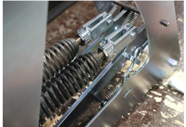
Figur 5a och 5b. Visar sprängbild av fjäderpaketet, samt fjäderpaketet ihopsatt. (egen bild)
