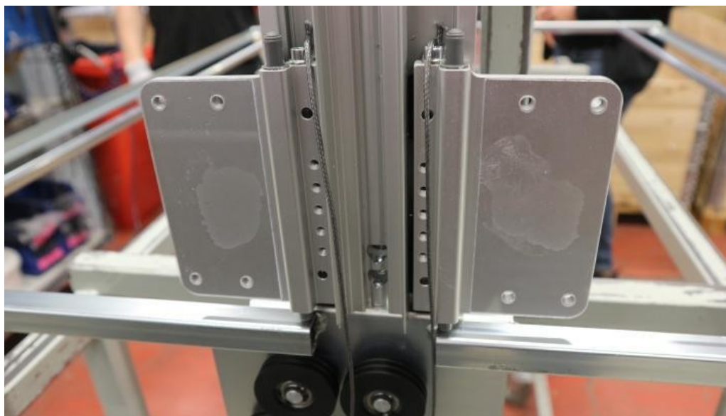
Figur 4. Illustrerar vagnarna som går i ett vertikalt spår längs med huvens öppningsbana. (egen bild)
