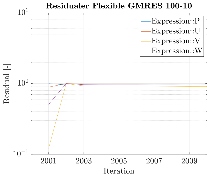
Figur D.3: Residualer för Flexible GMRES 100-10 och diskretisering på 2nd-order .
