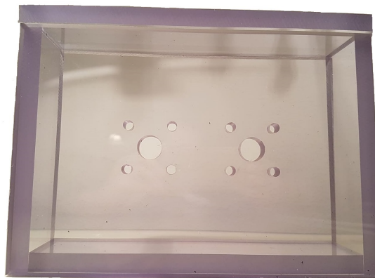
Figur 12: Frontvy av laserskurna väggar av polykarbonat
